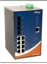
产品型号: IGPS-7084GP - 工业级 12 口网管型千兆 PoE 以太网交换机
